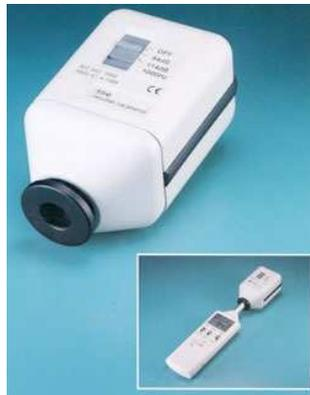
La calibración deberá realizarse siguiendo las instrucciones del fabricante y se suele realizar de forma vertical, insertando el micrófono en el hueco del calibrador.
